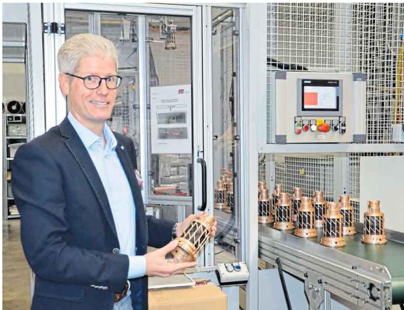
Geschäftsführer Volker Scheffels mit dem Schmutzsieb für einen Staubsauger. Das Sieb und die Kunststoffummantelung werden von einer Roboteranlage zu einem Komplettteil miteinander verbunden.
