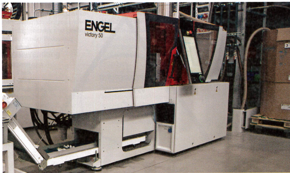
Beschleunigt das Rüsten und spart Platz: Die holmlose Victory-Maschine ist der bevorzugte Spritzgießmaschinentyp. Foto: Engel
