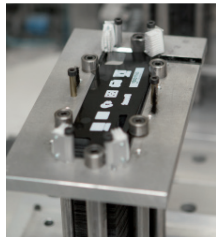
Die Fertigung der Bedienfelder startet mit den bedruckten, noch zweidimensionalen Labels.
